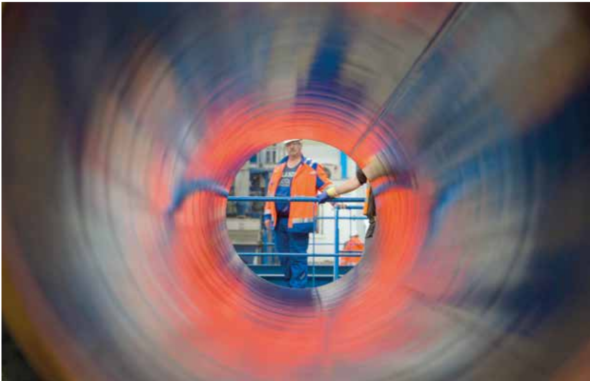
Vielschichtige Angelegenheit: In einer Fabrik auf der Insel Rügen werden die Rohre für die Pipeline Nord Stream 2 gefertigt. Die Ummantelung mit Stahlbeton verleiht ihnen das nötige Gewicht für die Verlegung auf dem Meeresboden.
